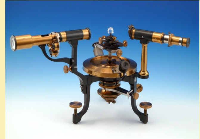
Reflektionsgoniometer der Firma Fuess, Ende 19. Jahrhundert. (Sammlung und Foto: Olaf Medenbach)
