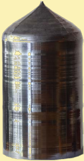
Silizium Kristall zur Herstellung von Wafern (Halbleiterscheiben) für Computerchips
